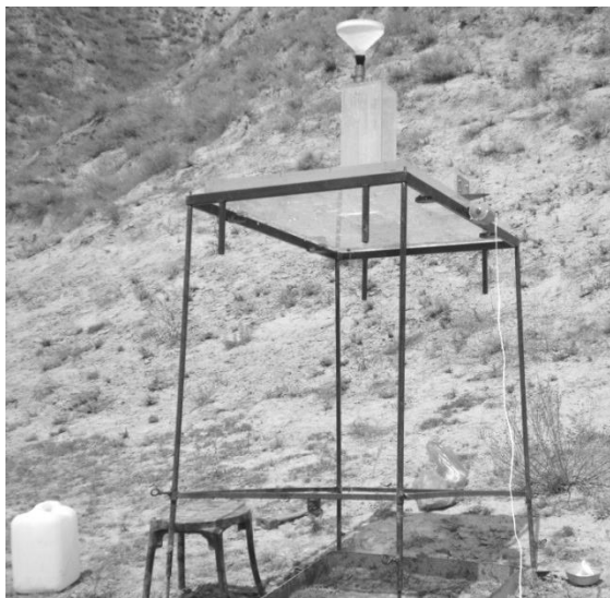
شکل ۲. دستگاه شبیه‌ساز باران مورد استفاده در این پژوهش
