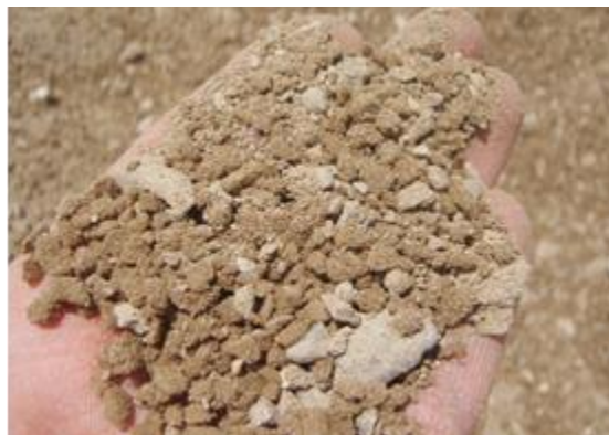
شکل ۲. روش مخلوط کردن خاک و ژل و خاکدانه‌های حاصل
