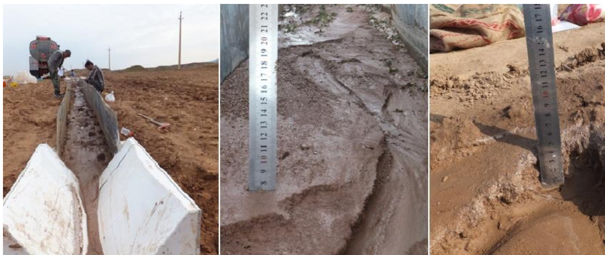
شکل ۳. اندازه‌گیری عمق کنش و رسوبات حاصل از جریان رواناب در پلات‌های صحرايي
