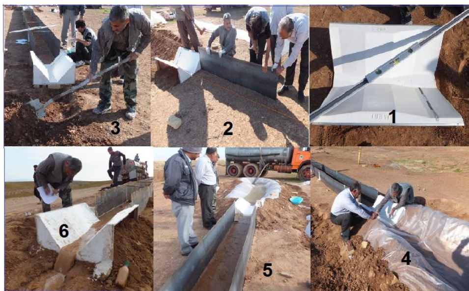
شکل ۲. مراحل نصب پلات صحرائی به ترتیب (۱) - نصب فلوم (۲) - نصب دیواره پلات صحرائی (۳) - پایاب (خروجی جریان) و محل نمونه برداری رسوب، (۴) - کانال نفوذ ناپذیر قبل از ورود جریان، به منظور ایجاد جریان یکنواخت (۵) - اشباع خاک و جریان هیدرولیک (شبیه سازی برای تعیین آستانه‌های هیدرولیک)، (۶) - فلوم انتهایی به منظور اندازه گیری دبی خروجی و رسوب
