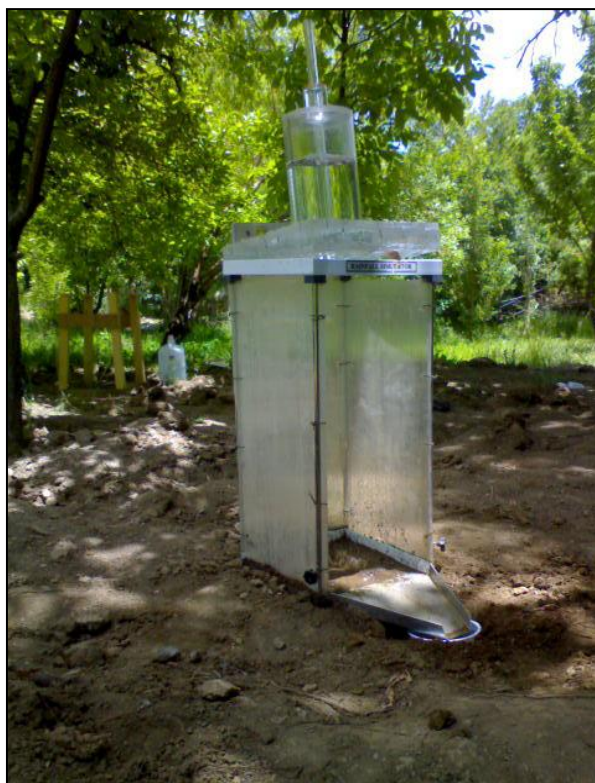
شکل ۳. دستگاه شبیه‌ساز باران مورد استفاده و نحوه استقرار آن در عرصه
