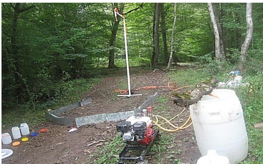
شکل ۲. تصویری از باران‌ساز مورد استفاده در این تحقیق با ارتفاع نازل ۳ متر
