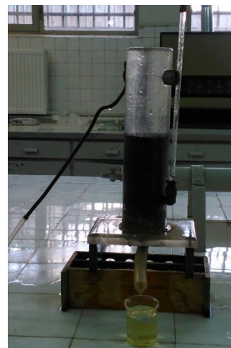
شکل ۱. شماتیک و تصویر دستگاه اندازه‌گیری هدایت هیدرولیکی در روش بار افتان [۳۲]
