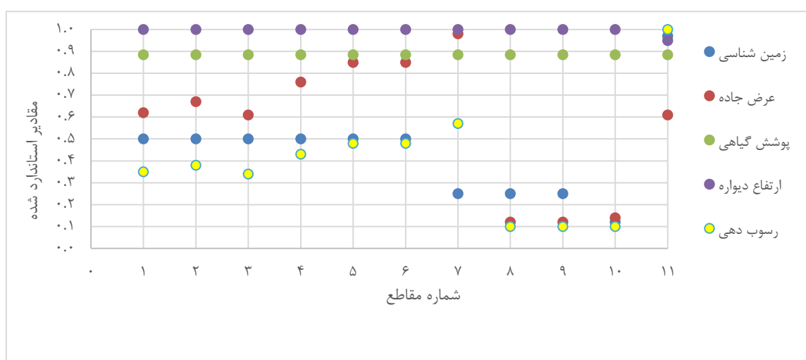
شکل ۶. حساسیت مدل WARSEM به عوامل متغیر اندازه‌گیری شده در دیواره خاک‌برداری
