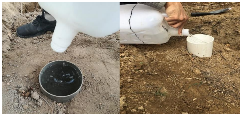
شکل ۲. نحوه پر کردن لوله پولیکا با آب جهت بررسی پیاز رطوبتی
