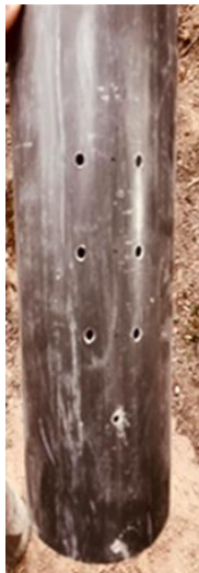
شکل ۱۱. لوله PVC به قطر ۱۶ سانتی متر با سه ردیف دو تایی سوراخ در بالا و دو سوراخ ۶ و ۴ میلی متری در پایین با ته بسته
