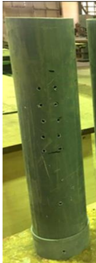
شکل ۷. لوله PVC به قطر ۱۲/۵ سانتی متر با پنج ردیف دو تایی سوراخ در بالا و دو سوراخ در پایین با ته بسته
