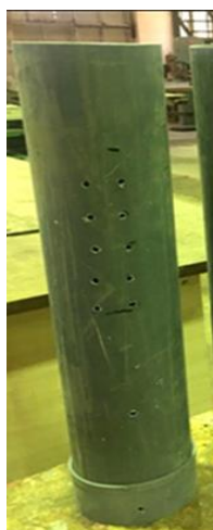
شکل ۶. لوله PVC به قطر ۱۲/۵ سانتی متر با پنج ردیف دو تایی سوراخ در بالا و سه سوراخ در پایین با ته بسته
