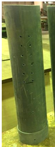
شکل ۸. لوله PVC به قطر ۱۲/۵ سانتی متر با شش ردیف دو تایی سوراخ در بالا و دو سوراخ در پایین با ته بسته
