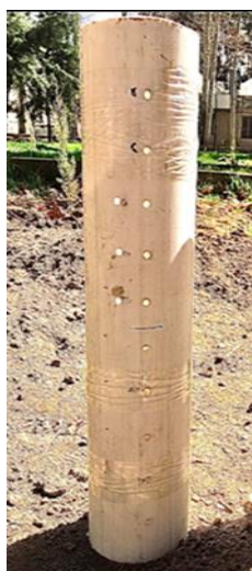
شکل ۵. لوله PVC به قطر ۱۲/۵ سانتی متر با سه ردیف دو تایی سوراخ در بالا و سه سوراخ در پایین با ته بسته
