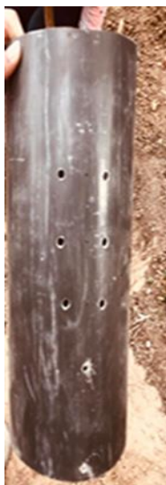
شکل ۱۲. لوله PVC به قطر ۱۶۰ میلی متر با سه ردیف دو تایی سوراخ در بالا و دو سوراخ در پایین با ته بسته
