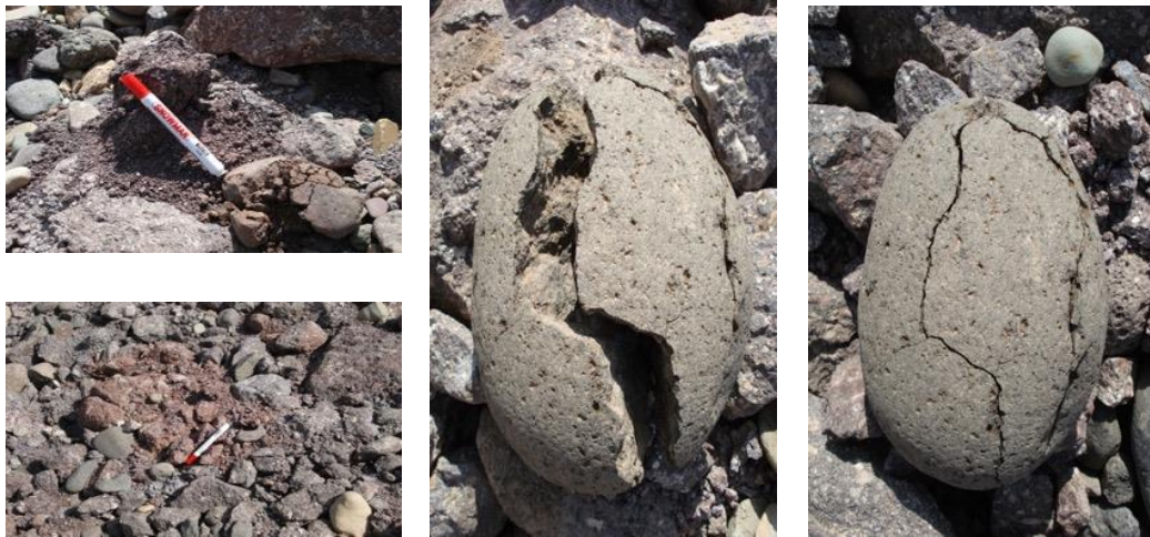
شکل ۵. سنگ‌های آذرین بیرونی استفاده شده بر روی ریپ‌رپ بدنه سد طالقان
